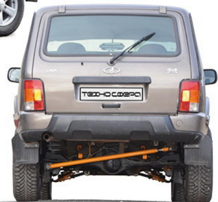
Комплект изделий («Лифт-комплект») поднимает кузов автомобиля на 40 мм, увеличивает дорожный просвет под днищем и балкой переднего моста.
